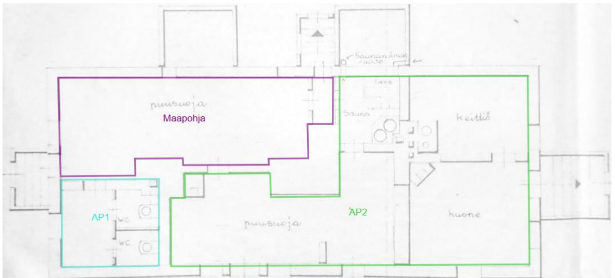
Kuva 26 Alapohjarakenteiden sijainnit pohjakuvassa esitettynä.
